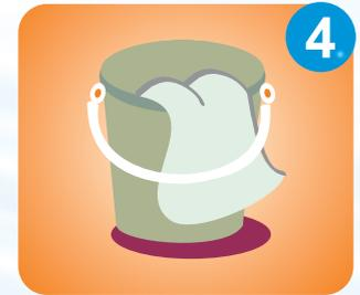
4. Com um pano, esponja e balde retire a sujeira e toda a água da lavagem. Abra a saída da caixa d'água deixando todas as torneiras fechadas e não use a descarga.
