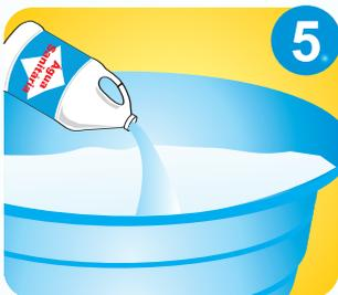
5. Deixe a caixa d'água encher. Acrescente 1 litro de água sanitária para cada 1.000 litros de água. Não consuma esta água por duas horas, para que haja a desinfecção.
