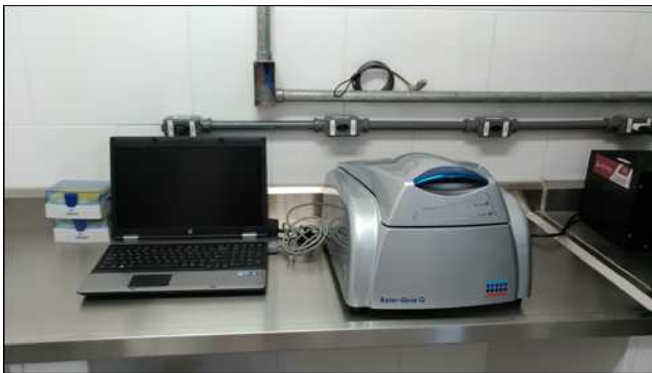
Figura 13 - Termociclador q-PCR, Rotor Gene Q – Qiagen. Utilizado para Reação de PCR em Tempo Real, no monitoramento de vírus entéricos em amostras hídricas.
